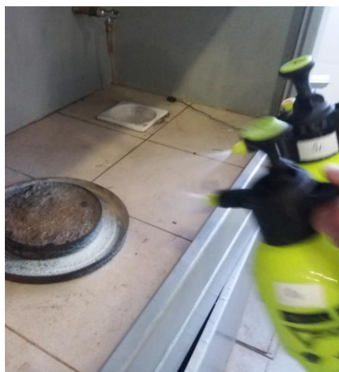
Рис. 4.26 – Етапи гасіння піску, який змочено бензином, за допомогою ГУС:
