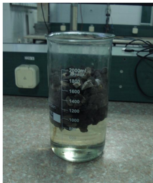
Рис. 2.5 – Розташування ПС на горючій рідині
