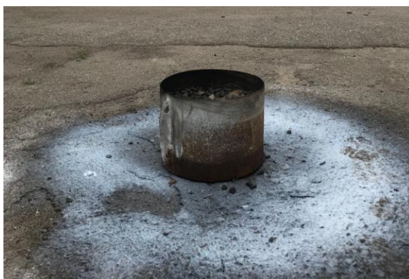
Рис. 4.17 – Повне погасання гасу
