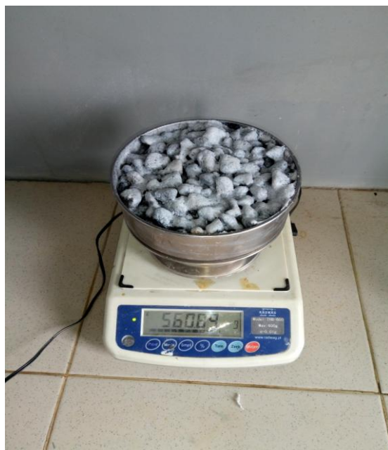
Рис. 3.12 – Зважування ємності з бензином, ізолюваної сіткою з бінарним шаром «ПС + гель»
