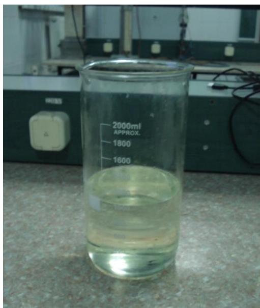
Рис. 2.4 – Рівень наливання горючої рідини
