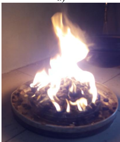
Рис. 4.25 – Етапи гасіння просоченого бензином піску за допомогою ПС та ГУС:
