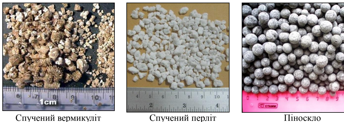
Рис. 2.1 – Силікатні матеріали, випробувані в якості легкого носія гелю в пілотних дослідженнях
