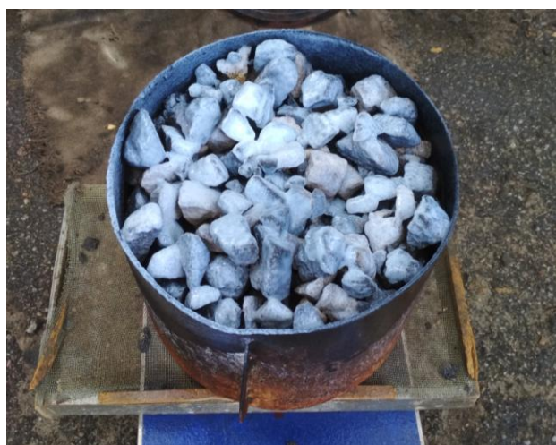
Рис. 4.12 – Припинення горіння у разі подавання ГУС (витрата 0,5 \text{ г/см}^2 )
