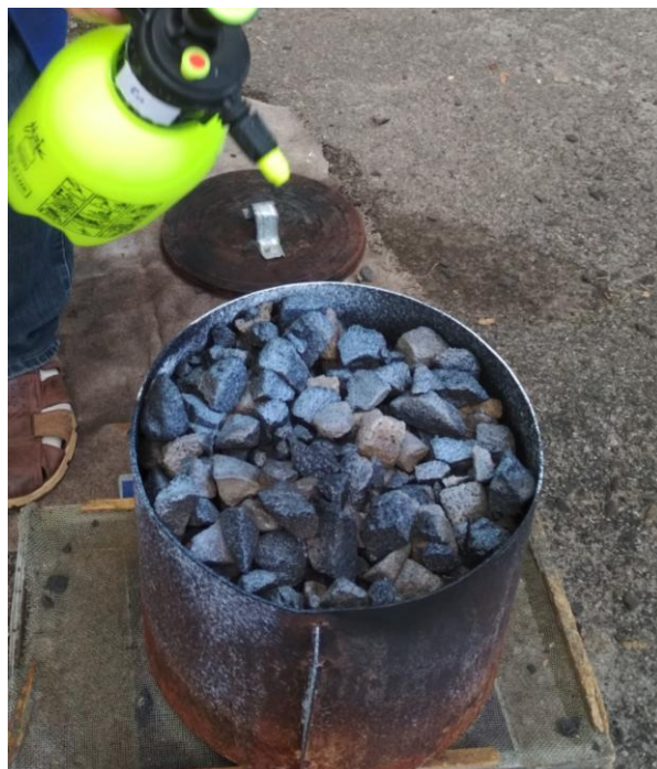
Рис. 4.11 – Завершення гасіння шляхом подавання ГУС – 0,2 \text{ г/см}^2 (стандартне вогнище 2В)
