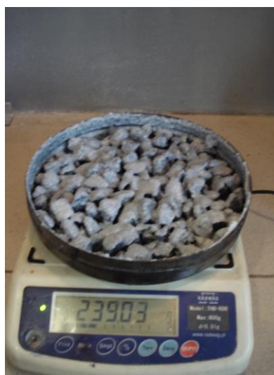
Рис. 2.8 – Створення суцільного шару гелю на поверхнях гранул ПС
