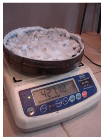
Рис. 2.9 – Створення суцільного шару гелю із заповненням проміжків між гранулами ПС
