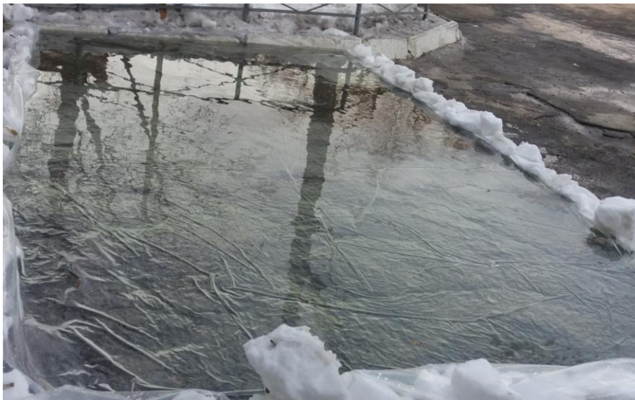
Рис. 7.8 – Зовнішній вигляд ємності для дослідження розподілу гранул піноскла по поверхні рідини
