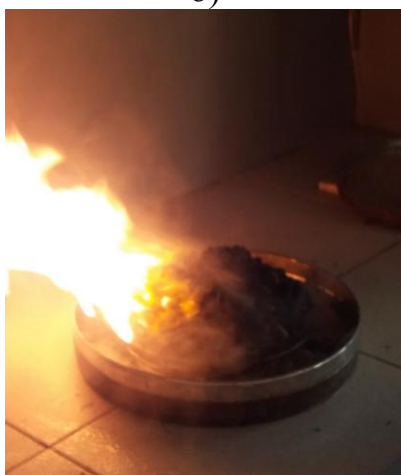
Рис. 4.25 – Етапи гасіння просоченого бензином піску за допомогою ПС та ГУС:
