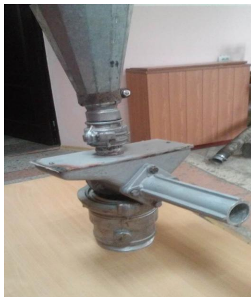
Рис. 2.6 – Ежекційний апарат для подавання гранульованого піноскла
