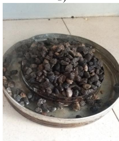
Рис. 4.25 – Етапи гасіння просоченого бензином піску за допомогою ПС та ГУС:
