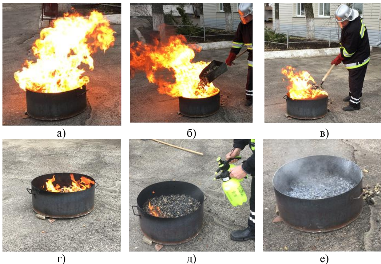
Рис. 4.24 – Етапи гасіння модифікованого вогнища пожежі 8В:
