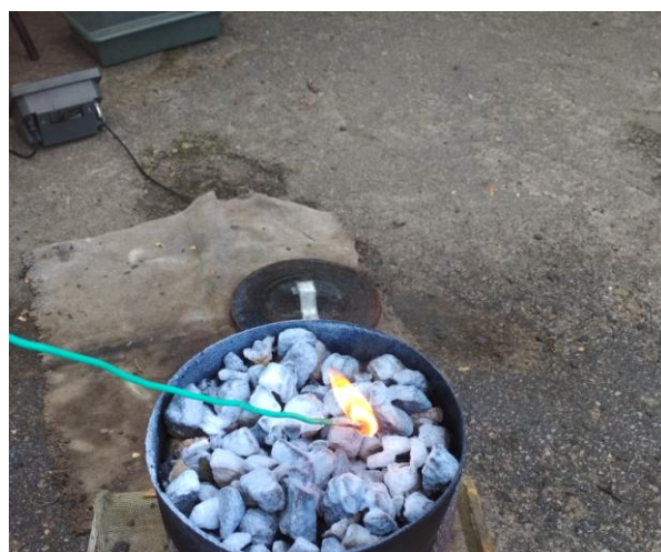
Рис. 4.13 – Перевірка відсутності повторного займання
