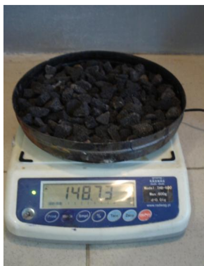
Рис. 2.7 – Зважування шару ПС без шару гелю
