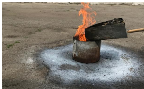
Рис. 4.15 – Засипання змоченого ПС
