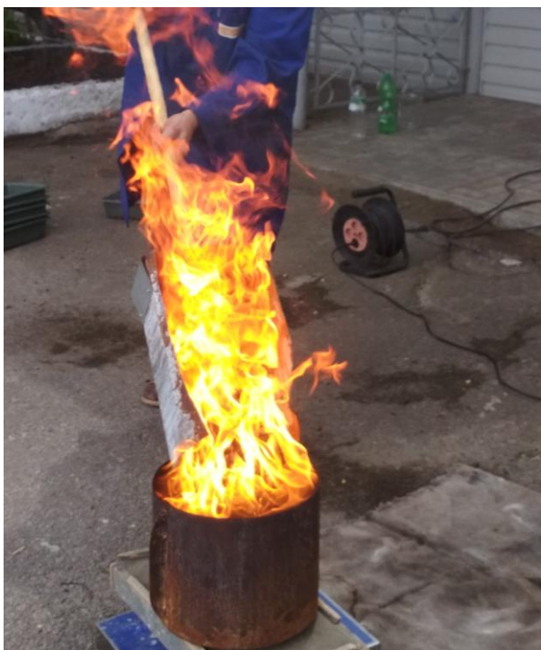
Рис. 4.18 – Інтенсифікація горіння на початку подавання змоченого ПС
