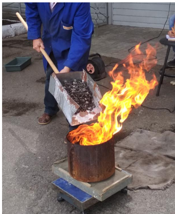
Рис. 4.19 – Послаблення горіння під час подавання другої порції змоченого ПС
