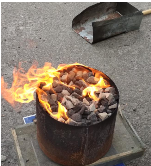
Рис. 4.10 – Інтенсивність горіння бензину за максимального шару ПС (стандартне вогнище 2В)
