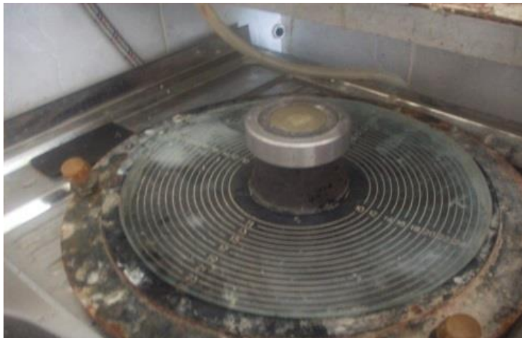
Рисунок 1 – Конус розтічності цементного тіста КР-1 АЗНДІ
