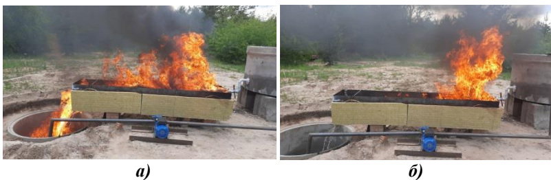
Рис. 1. Фрагмент натурних випробувань стенду масла приймача: a – ухил маслоприймача у бік напрямку 0 м, б – ухил маслоприймача у бік напрямку 0,05 м
