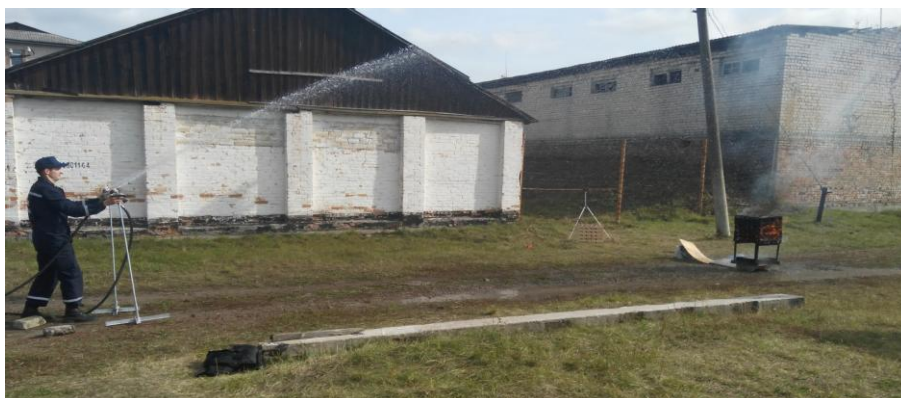
Рис. 5. Процесс дистанционного тушения водой модельного очага 1А из двух стволов-распылителей, где в течении отрезка времени около 25с было израсходовано 9,2 литров воды (каждым по 4,6л)
