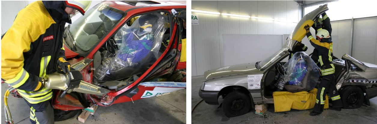
Рис. 1 Технології видалення елементів кузова автомобіля: а - видалення дверей зі сторони постраждалого; б - видалення даху.
