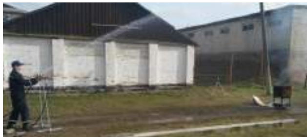
Рисунок 1. – Формування експериментальних даних для аналітичної побудови траєкторій руху струменів, що подаються з установки АУГГУС-М.
