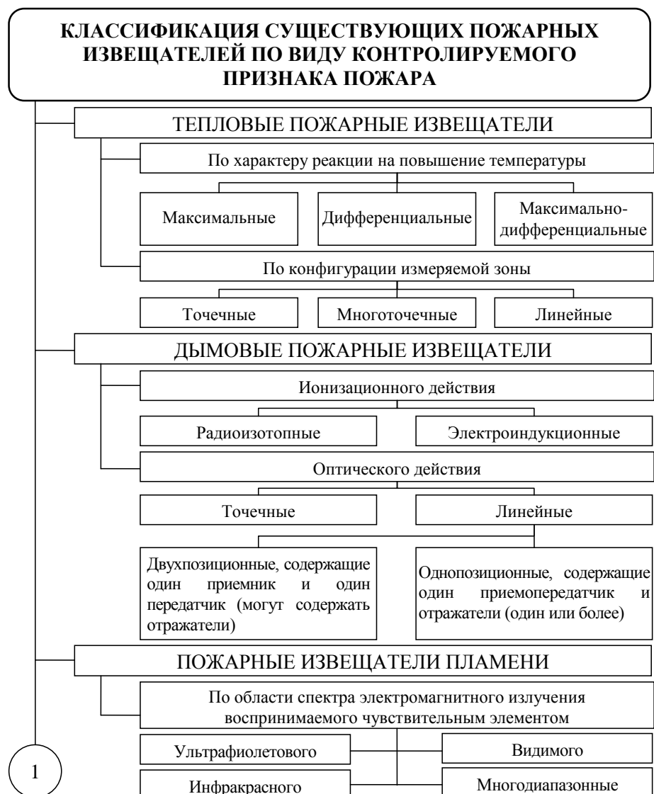
Рис. 5. Классификация существующих пожарных извещателей по виду контролируемого признака пожара
