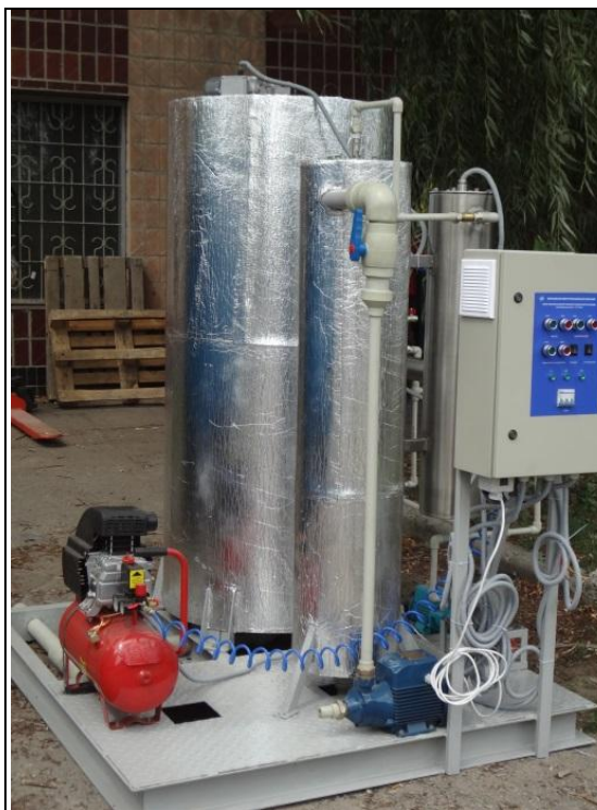
Рис. 3. Мобільна дослідно-промислова установка очищення стічних вод від токсичних речовин.
