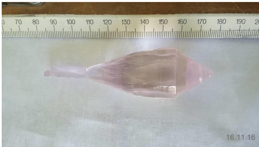
Рисунок 1 - Кристал YAG:Er, вирощений методом Чохральського з іридієвого тигля
