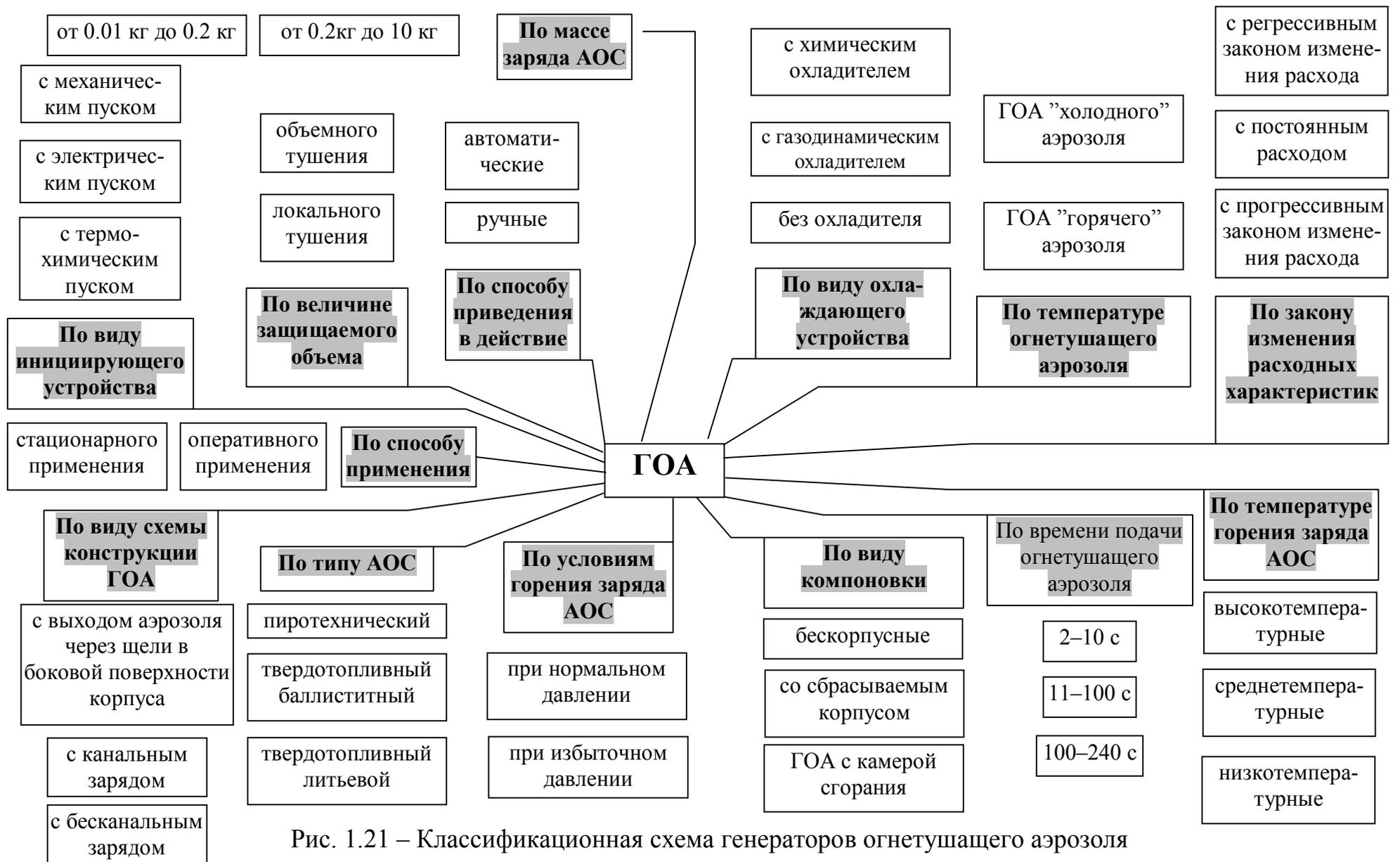
Рис. 1.21 – Классификационная схема генераторов огнетушащего аэрозоля
