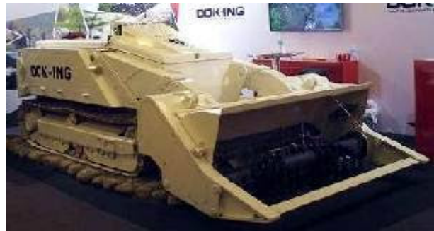
Рис. 2. Машина для розмінування з дистанційним керуванням MV-4.
