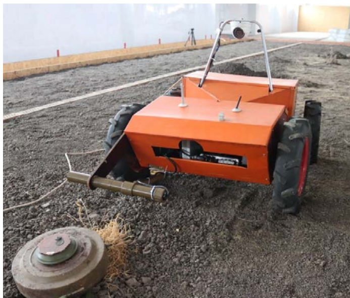
Рис. 1. Дослідна дистанційно-керована наземна платформа (ДКНП).
