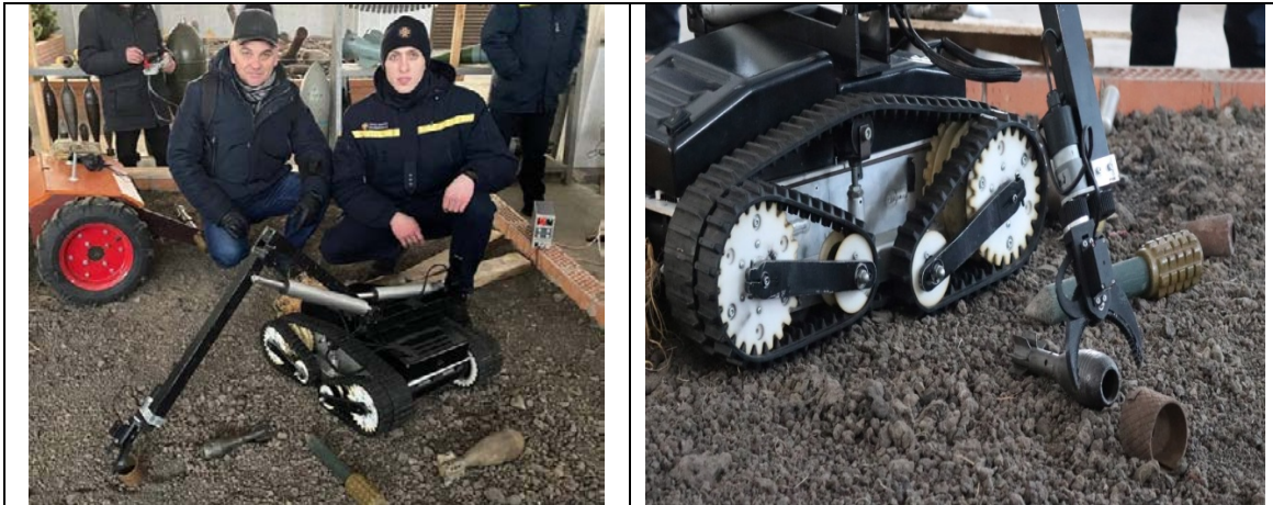
Рис. 2. Дослідна дистанційно-керована наземна платформа (ДКНП) для виконувати завдання зі знешкодження вибухонебезпечних предметів в умовах пересіченої місцевості.
