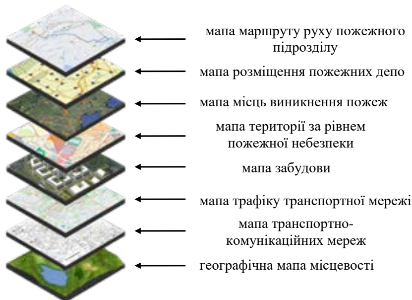
Рис. 1. Структура геоінформаційних систем управління пожежними підрозділами різної функціональної спроможності.
