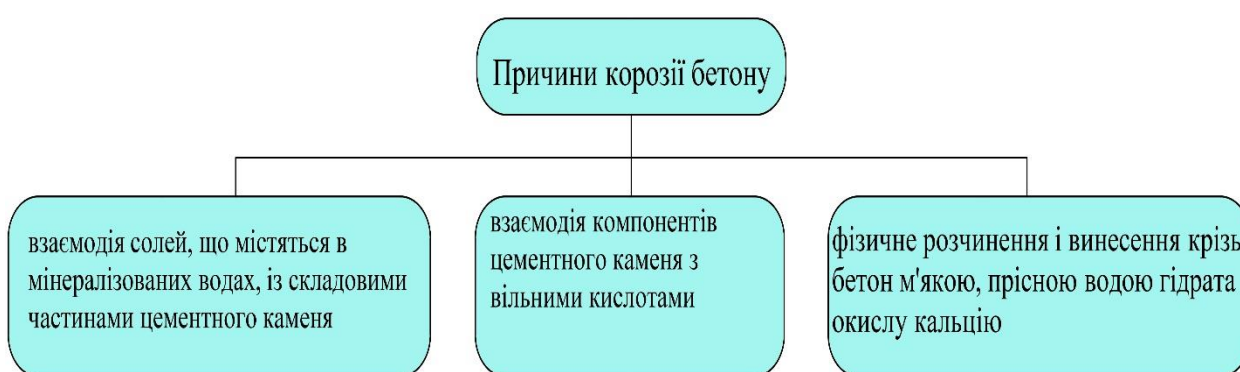
Рисунок 3 Причини корозії бетону
