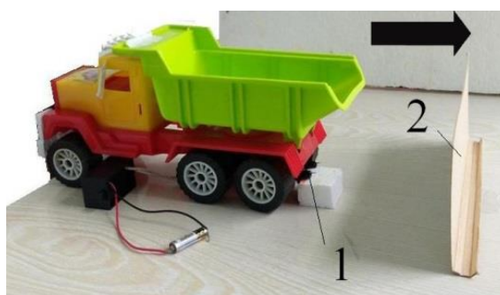
Рисунок 1 – Експериментальна установка: 1 – іонізатор; 2 – захисний екран
