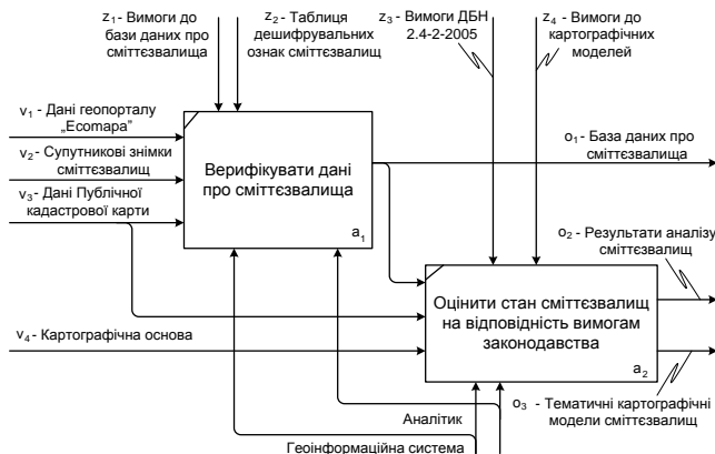
Рис. IDEF0 – модель процесу як структура інформаційної технології аналізу показників при оцінюванні стану сміттєзвалищ
