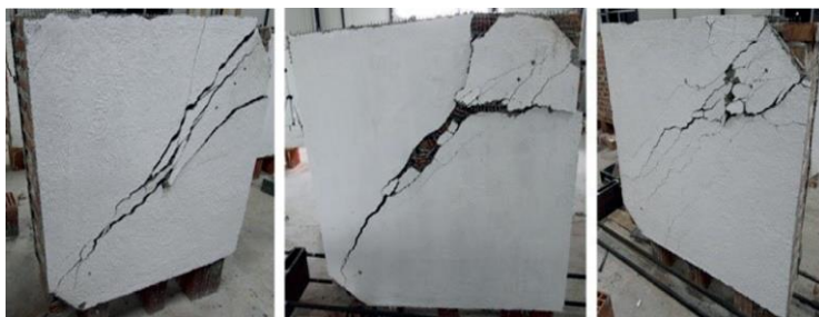
Рис.2. Характер руйнування дослідних зразків, підсилених шаром розчину, армованого сіткою із скловолокна [9]
