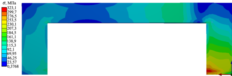
Рис. 1. Розподіл еквівалентних напружень \sigma за Місесом на податливій поверхні клину
