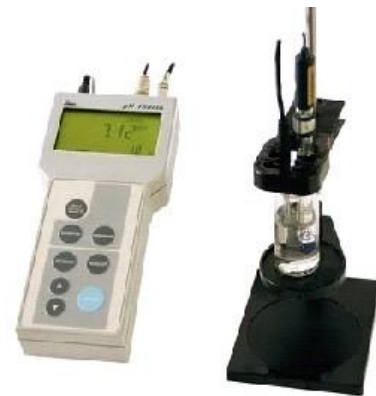
Рисунок 2.4 – Зовнішній вигляд рН-метра рН-150МА
