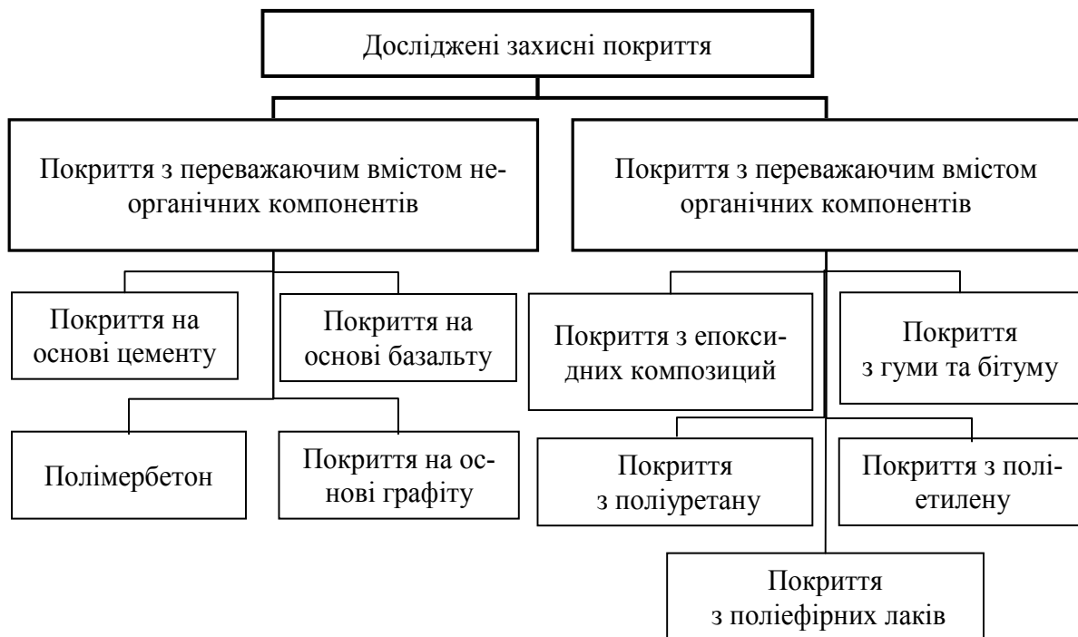
Рисунок 4.6 – Схема класифікації покриттів, які досліджували, за основним компонентом, що входить до складу матеріалу
