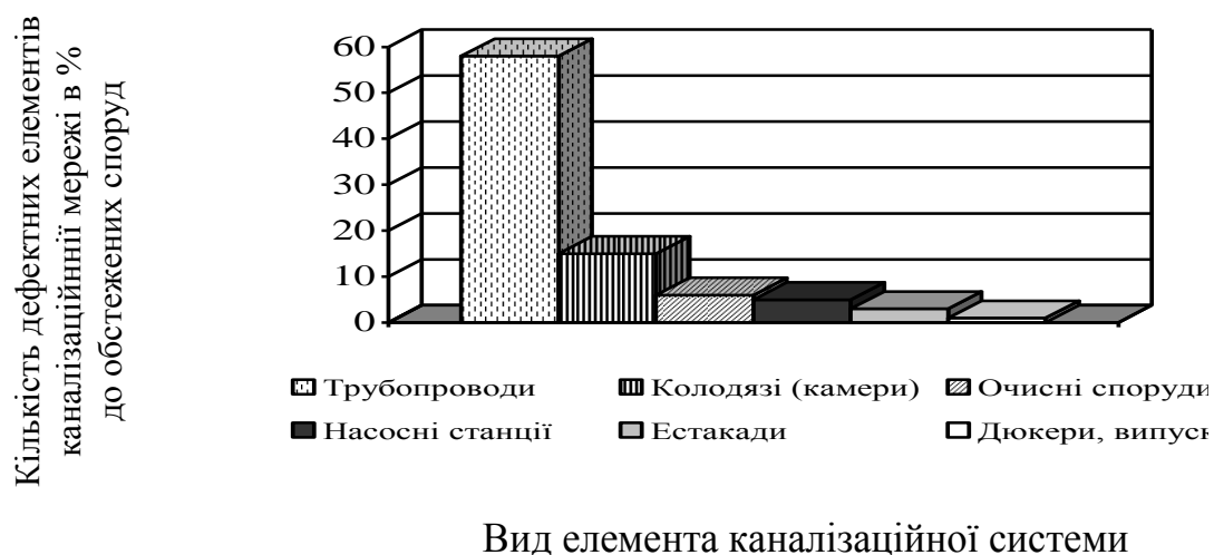
Рисунок 1.2 – Розподіл дефектів споруд у системі каналізації
