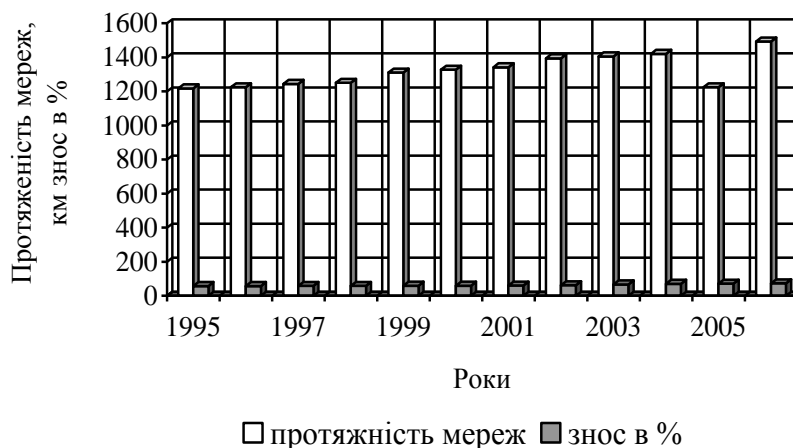
Рисунок 1.4 – Протяжність інженерних мереж та їх знос у м. Харкові
