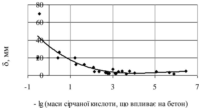
Рисунок 2.11 – Вплив маси сірчаної кислоти, що діє на бетон протягом певного періоду часу, на глибину дифузії біогенних кислот за фронт корозії
