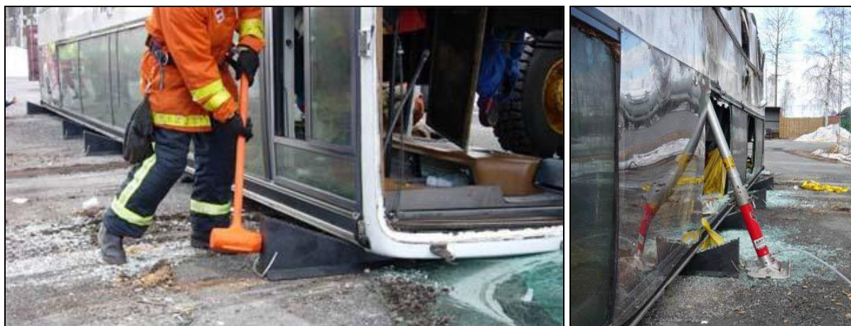
Рисунок 4.8 – Схема фіксації автобусу на даху
