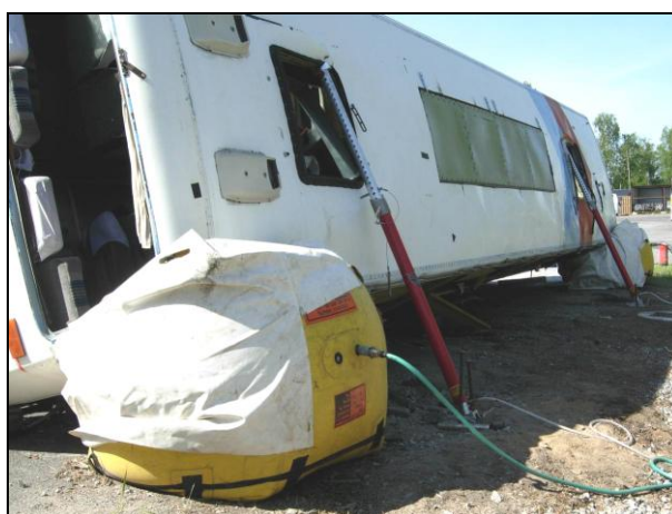
Рисунок 4.10 – Схема підйому автобусу за допомогою гідроциліндрів
