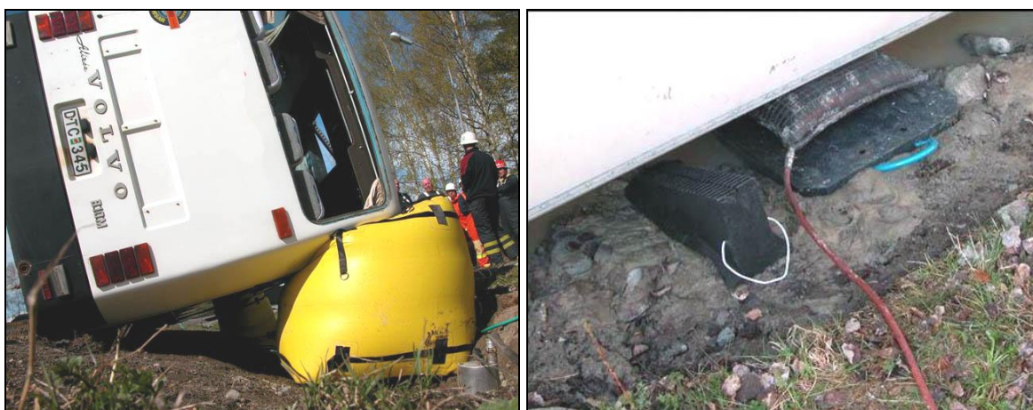
Рисунок 4.11 – Схема підйому автобусу пневматичними подушками
