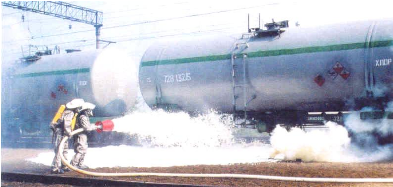
Рисунок 2.6 – Ізоляція розливу НХР піною середньої кратності.
