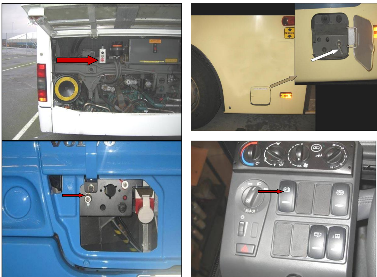
Рисунок 4.2 – Місця аварійного відключення двигуна автобусу
