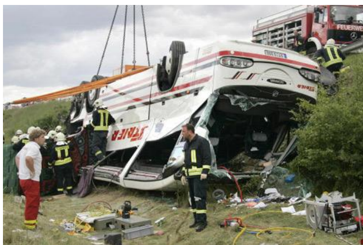
Рисунок 4.7 – Схема фіксації автобусу на даху за допомогою крану
