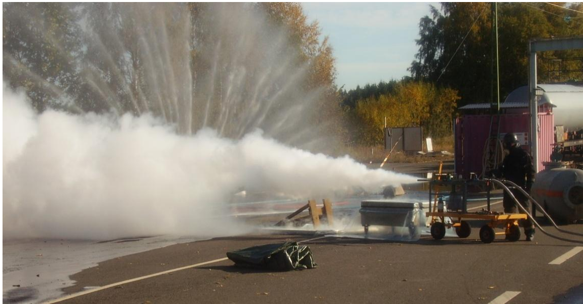
Рисунок 2.7 – Постановка водяної завіси на шляху поширення парів аміаку
