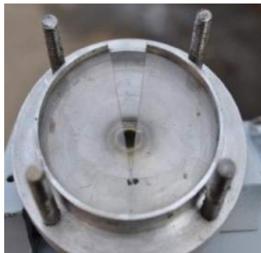
Рис. 2. Ствол-розпилювач СР – 10: а – збірна схема; б – ствол з відкритою кришкою.
