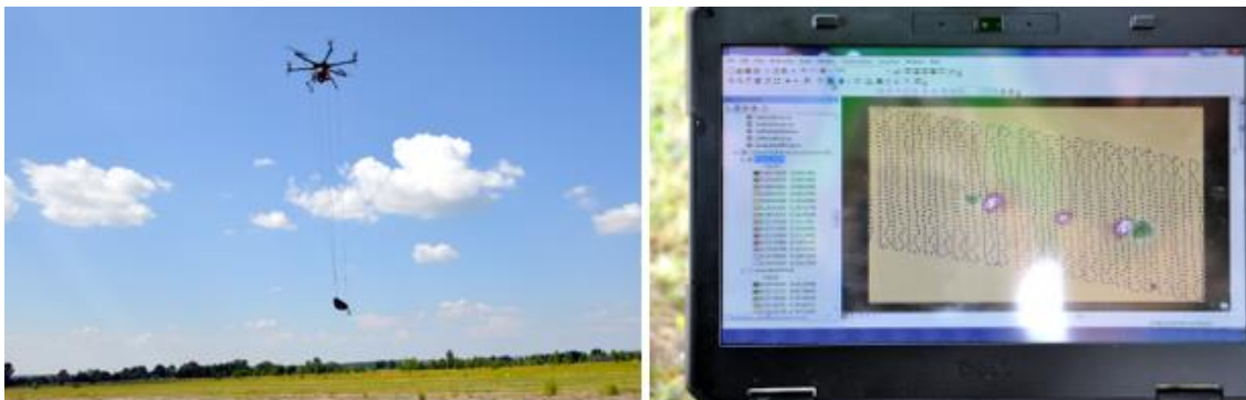
Рисунок 1 – Робота мультикоптера з датчиками магнітометру
