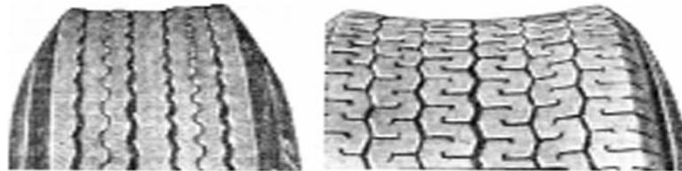
Рисунок 1 – Шини з ребристим дорожнім рисунком, які мають зворотну кривизну протектора.
