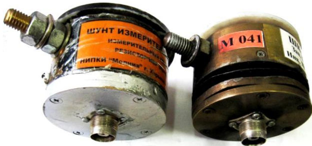
Рис. 4. Общий вид измерительного коаксиального шунта типа ШК-300 до (слева) и после (справа) протекания через него в сильноточной разрядной цепи высоковольтного ГИТМ-10/350 нормированного аperiodического импульса тока искусственной молнии временной формы 15/315 мкс с амплитудой I_{mL} \approx 184 кА ( q_L \approx 81,3 Кл; J_L \approx 7,88 \cdot 10^6 А 2 ·с)
