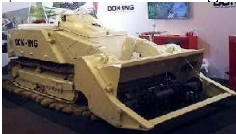
Рис. 2 – Машина для розмінування з дистанційним керуванням MV-4.
