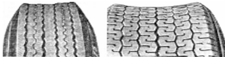
Рисунок 1 – Шини з ребристим дорожнім рисунком, які мають зворотну кривизну протектора.
