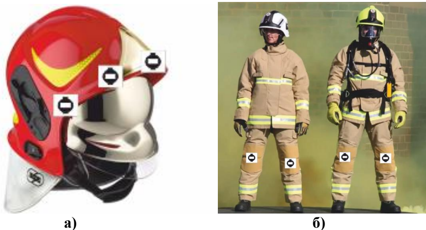
Рисунок 1 – Схема розміщення акустичних датчиків на захисному шоломі (а) та одязі рятувальника(б) - (☐ - акустичний датчик).
