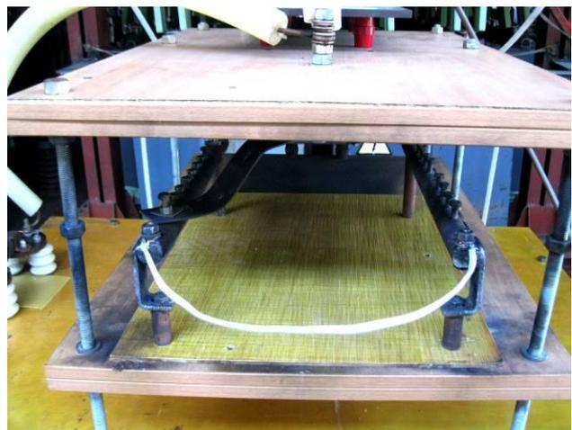
Рис. 8. Внешний вид рабочего стола генератора типа ГИТМ-10/350 с жестко закрепленными на его массивных стальных электродах сплошными круглыми медными жилами общим сечением  $S_1 \approx 5$  мм<sup>2</sup> ОО провода марки ПНП 2х2,5 с ПВХ изоляцией длиной 0,5 м до воздействия на них аperiodического импульса тока 15/335 мкс искусственной молнии амплитудой около  $I_{mL} \approx 85,6$  кА ( $U_{31-3} \approx 16,5$  кВ;  $U_{34} \approx 4,2$  кВ)
