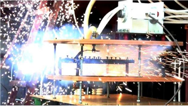
Рис. 12. Промежуточная стадия ЭВ сплошной круглой алюминиевой жилы сечением  $S_1 \approx 6 \text{ мм}^2$  ОО провода марки АППВнг2х6 с ПВХ изоляцией длиной 0,5 м в сильноточной разрядной цепи генератора типа ГИТМ-10/350
