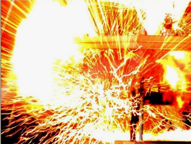
Рис. 5. Начальная стадия ЭВ медной жилы сечением  $S_1 \approx 3,2$  мм<sup>2</sup> ОО радиочастотного коаксиального кабеля марки РК 50-7-11 со сплошной ПЭТ изоляцией длиной 0,5 м в сильноточной разрядной цепи генератора типа ГИТМ-10/350
