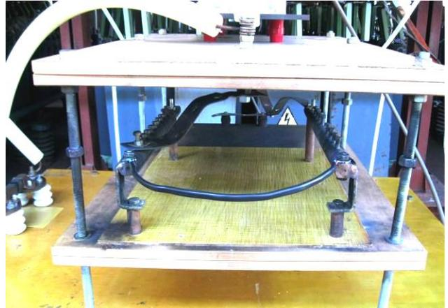
Рис. 10. Внешний вид рабочего стола генератора типа ГИТМ-10/350 с жестко закрепленной на его массивных стальных электродах сплошной круглой алюминиевой жилой сечением  $S_1 \approx 6 \text{ мм}^2$  ОО провода марки АППВнг2х6 с ПВХ изоляцией длиной 0,5 м до воздействия на нее аperiodического импульса тока 15/335 мкс искусственной молнии амплитудой около  $I_{mL} \approx 85,6 \text{ кА}$  ( $U_{31-3} \approx 16,5 \text{ кВ}$ ;  $U_{34} \approx 4,2 \text{ кВ}$ )
