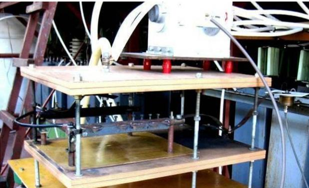
Рис. 13. Внешний вид провода марки АППВнг2х6 с ПВХ изоляцией длиной 0,5 м с его параллельно подключенными к электродам рабочего стола генератора типа ГИТМ-10/350 двумя алюминиевыми жилами общим сечением  $S_1 \approx 12 \text{ мм}^2$  до воздействия на них импульса тока 15/335 мкс искусственной молнии амплитудой  $I_{mL} \approx 83,8 \text{ кА}$  (справа отчетливо виден измерительный шунт типа ШК-300 [7,10], включенный в сильноточную разрядную цепь данного генератора)
