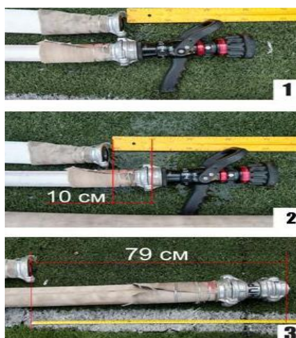
Рис. 1. Вимірювання зміни довжини досліджуваних пожежних рукавів
