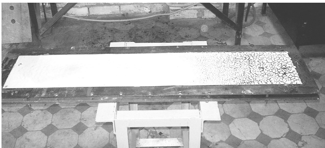
Рис. 5. Зовнішній вигляд досліджуваного зразка ДВП, обробленого ГУС \text{Na}_2\text{O} \cdot 2,95\text{SiO}_2 - 16,56\% , \text{CaCl}_2 - 2,76\% , товщиною шару 2 мм після випробувань (критична поверхнева густина теплового потоку 15,17 \text{ кВт/м}^2 )
