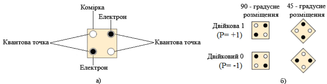
Рисунок 1. Базова комірка КА (а), два способи її розміщення в просторі та поляризації електронів (б).
