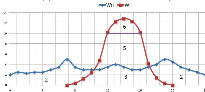
Рис. 10. Графіки роботи мережевої електростанції
