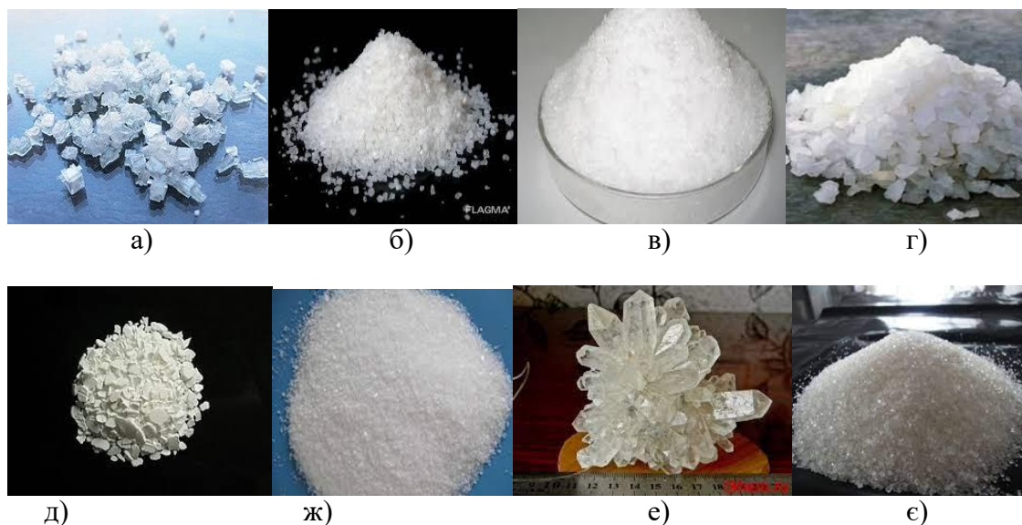
Рис. 2. Загальний вигляд першого типу модифікованих добавок: а) NH 4 Cl; б) NaCl; в) KCl; г) MgCl 2 ; д) CaCl 2 ; ж) (NH 4 ) 2 HPO 4 ; е) NH 4 H 2 PO 4 ; є) (NH 4 ) 2 SO 4
