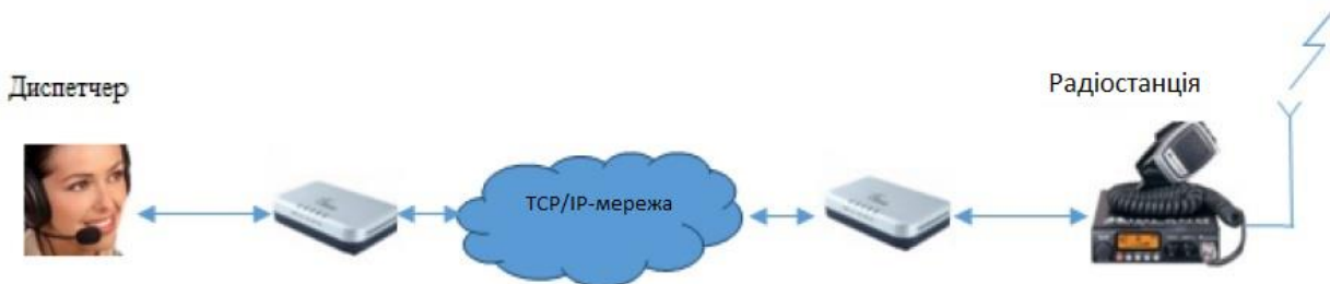
Рис. 1. Схеми організації зв'язку радіостанції з пультом дистанційного управління через IP-мережу
