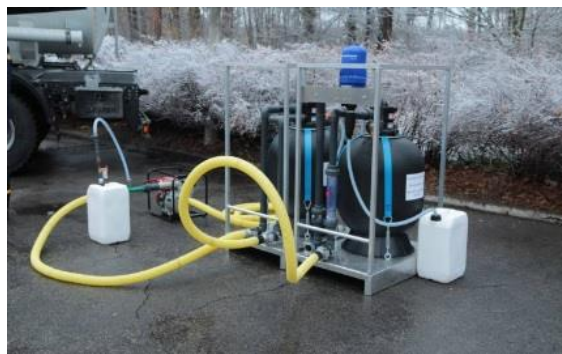
Рис. 1. Автономна водоочисна установка
