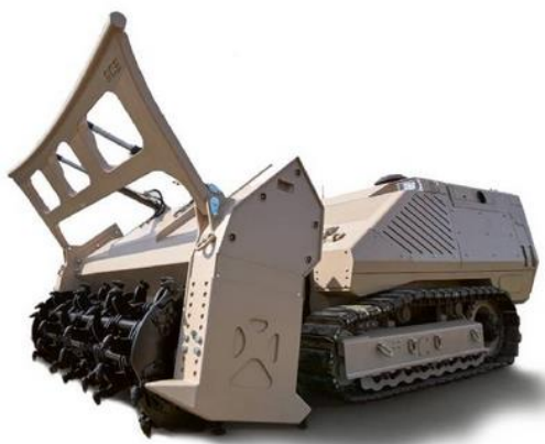
Рис. 1. Багатоцільова безпілотно платформа для розмінування GCS-200
