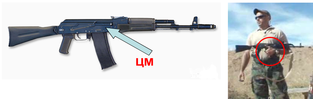
Рис. 1. Расположение центра масс автомата АК-74
