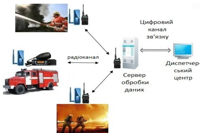
Рис. 1. Передача даних GPS-трекерів по радіоканалам управління
