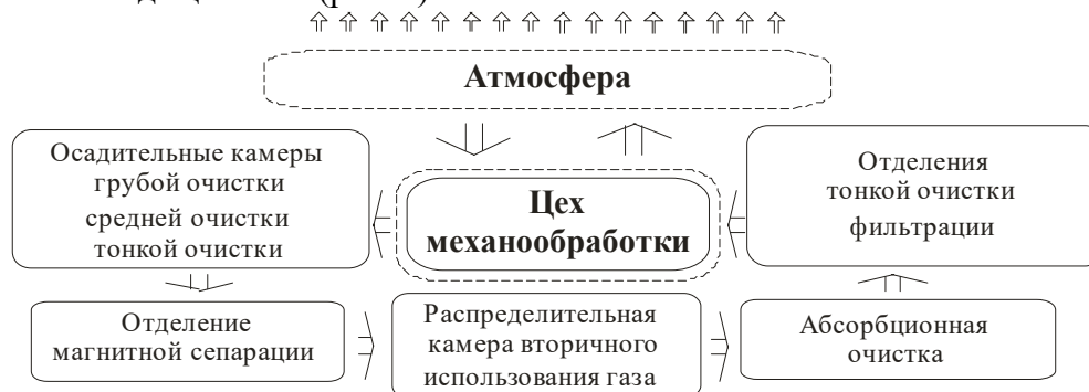
Рис. 1. Схема системы улавливания и обезвреживания вредных выбросов от механического производства
