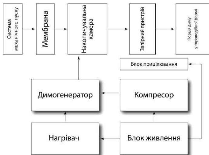
Рис. 1. Структурна схема пристрою для дистанційної перевірки димових пожежних сповіщувачів
