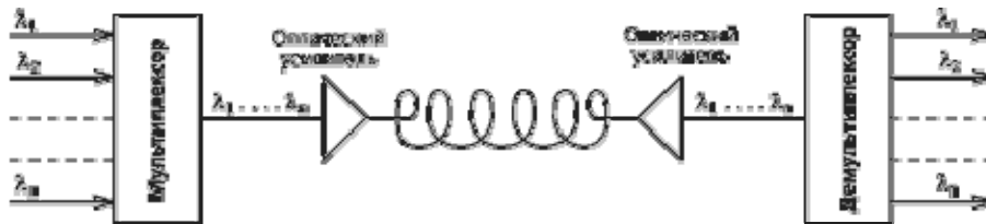
Рис. 1. Принцип работы волоконно-оптических систем связи со спектральным мультиплексированием
