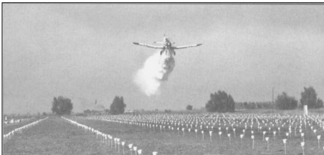
Рисунок 1 – Сброс воды с пожарного самолета с использованием чаше-сеточного метода
