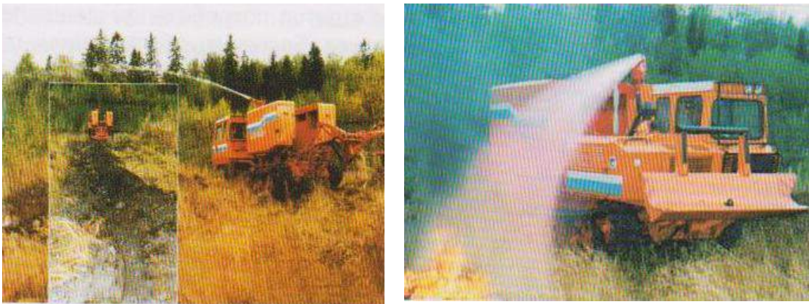
Рис. 1 – Робота та зовнішній вигляд лісопожежного трактора ЛХТ-100А-ЕФЕР
