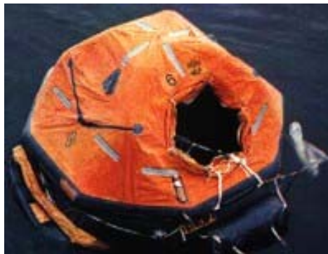
Рис. 1 - Рятувальний пліт ПСН-6МК
