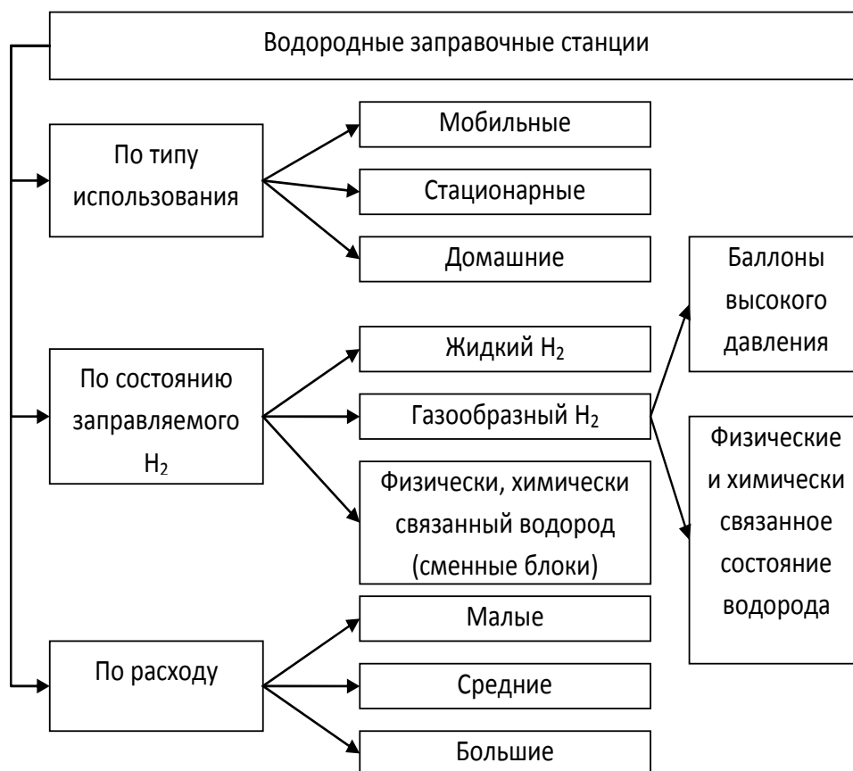
Рис. 1 – Классификация водородных заправочных станций
