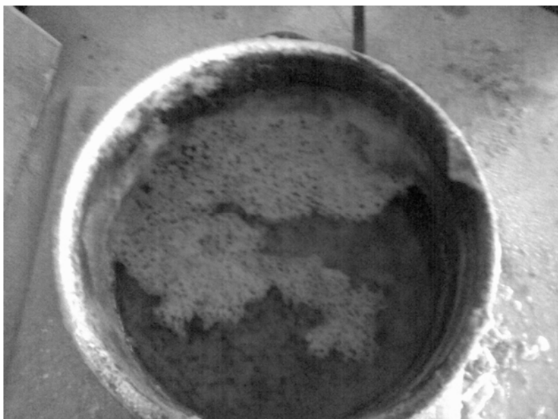
Рис.1 – Зовнішній вигляд модельного вогнища пожежі класу В, який був ліквідований гелево-бульбашковою плівкою
