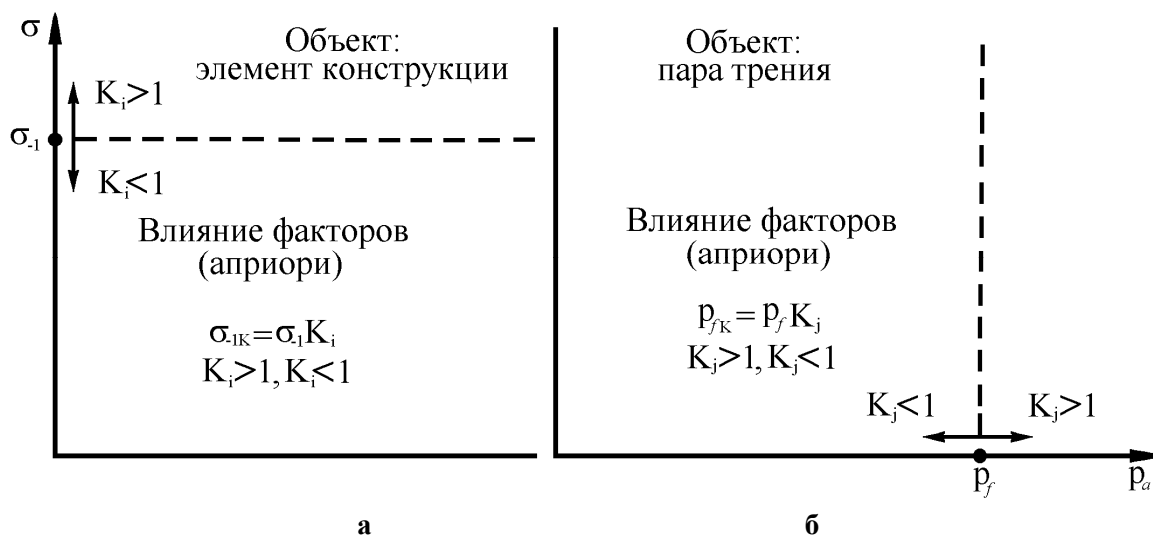
Рис. 1 – Схема анализа факторов, которые влияют на изменение характеристик сопротивления усталости (а) либо износостойкости (б): а) механическая усталость: объемное разрушение; б) трение (и изнашивание): поверхностное (контактное) повреждение
