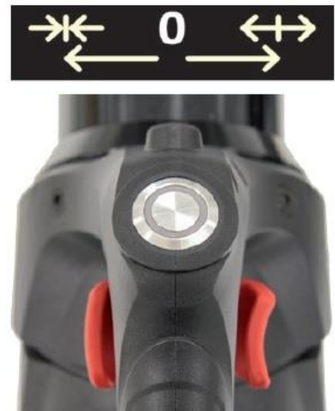
На прикладі різача - натискати: праворуч - леза розкрити, ліворуч - леза закрити
