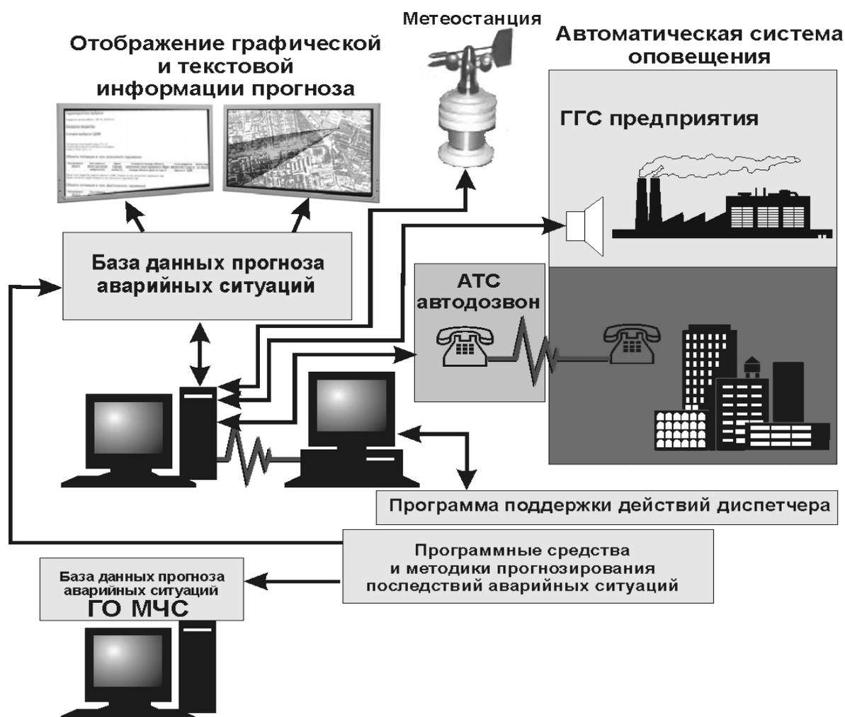
Рис. 6.1. Структурная схема автоматизированного программно-аппаратного комплекса поддержки принятия решений диспетчерской службы при возникновении и развитии аварий
