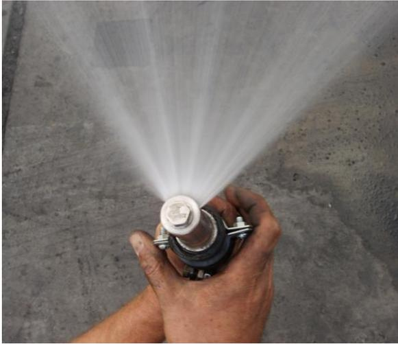
Рис. 6.10. Распылитель веерного типа
