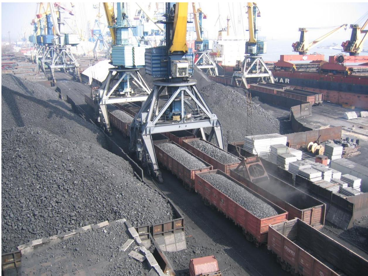
Рис. 6.9. Выгрузка угля из вагона без применения системы пылеподавления
