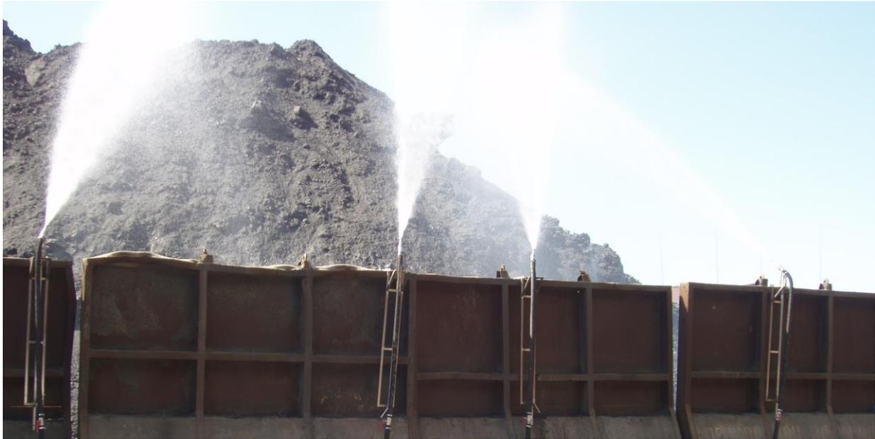
Рис. 6.16. Испытание группы лафетных распылителей в процессе погрузки угля
