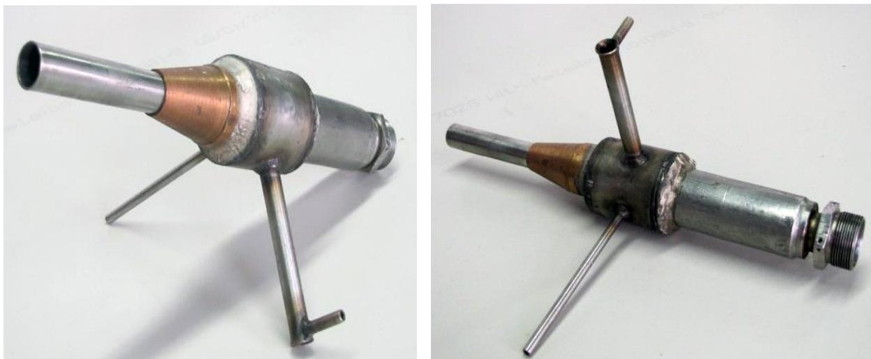
Рис. 5.22. Внешний вид водовоздушного эжекторного распылителя
