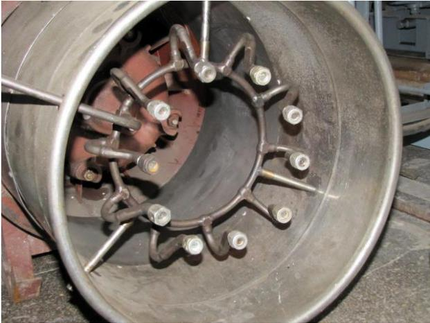
Рис. 5.5. Диспергатор, использующий для распыления жидкости форсунки
