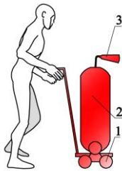
Рис.4. Пересувний засіб пожежогасіння: 1 – платформа; 2 – балон із вогнегасною речовиною та із стисненим повітрям; 3 – форсунки
