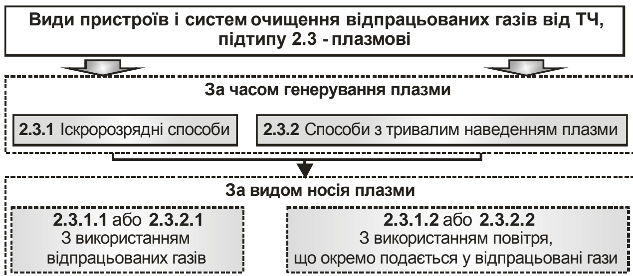
Рис. 2.21. Поділ пристроїв і систем очищення відпрацьованих газів від ТЧ термічного підтипу на види за принципом роботи
