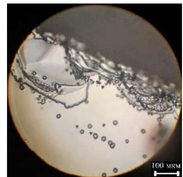
Рис. 3 – Порушення підкладки після скрайбування
