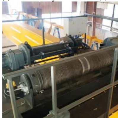
Фото 5. Компонування візка з двома гаками
