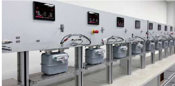
Рисунок 1 – Стенд для повірки газових лічильників
