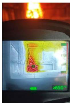
Рис. 3. а) Температура в осередку пожежі на 10 хвилину вільного розвитку
