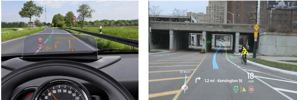
Рис. 1. Голографічний дисплей Panasonic Head-UP з використанням AR [6]
