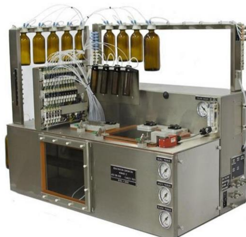
Рис. 2. Синтезатор олігонуклеотидів MerMade 12 призначений для синтезу олігонуклеотидів ДНК, РНК і LNA
