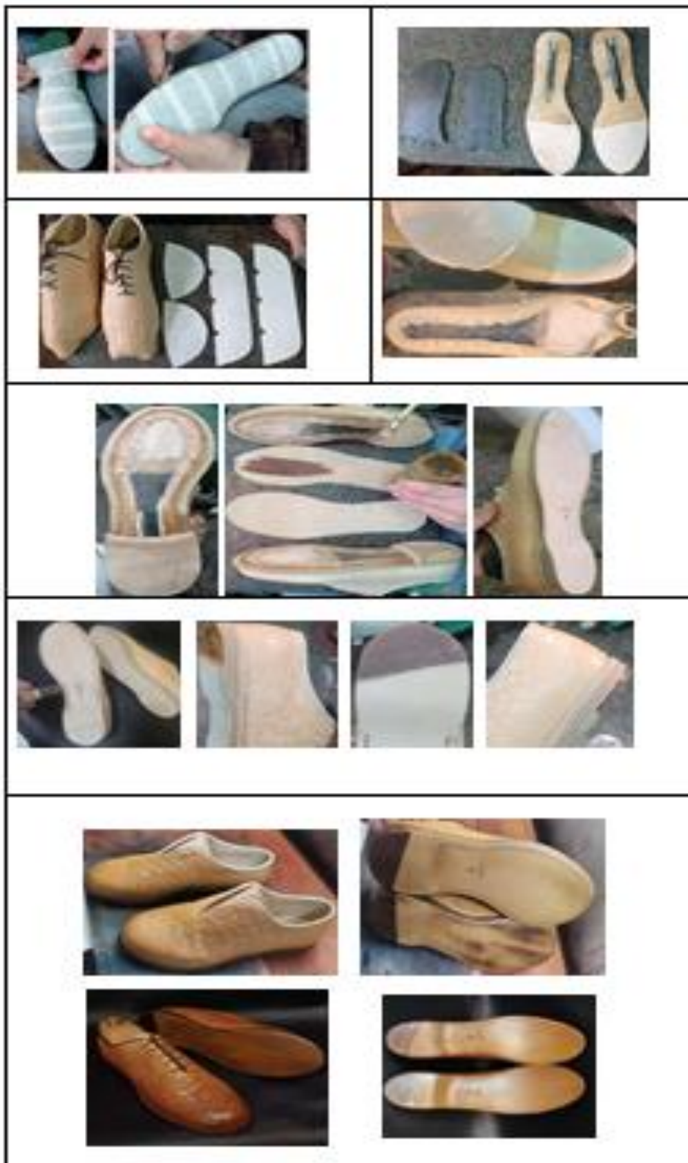
Рис. 3 Візуалізація етапів технології виготовлення та фінішного оздоблення чоловічого взуття за індивідуальним замовленням в стилі сучасна класика Для виготовлення дослідних зразків чоловічих напівчеревиків в стилі
