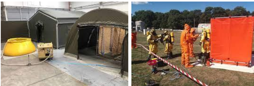
Рис. 1. Види розбірних ємностей для забезпечення робіт з деконтамінації.
