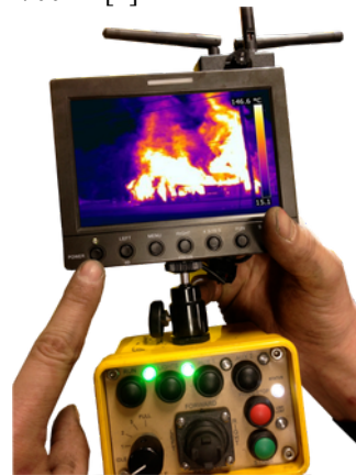
Рисунок 3. – Пульт дистанційного керування Thermite 3.0
