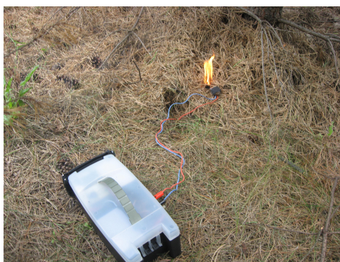
Рисунок 1 – Дослідження займання хвойної підстилки з використанням Пристрою для дослідження займистості горючого матеріалу з використанням електронагрівального елемента (фото автора)
