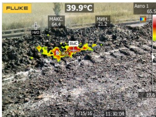
Рисунок 1 – Цифрове зображення осередків горіння породного відвалу із відмітками середніх, максимальних та мінімальних температур
