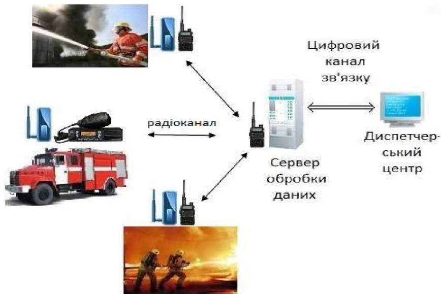
Рис. 1 – Передача даних GPS-трекерів по радіоканалам управління
