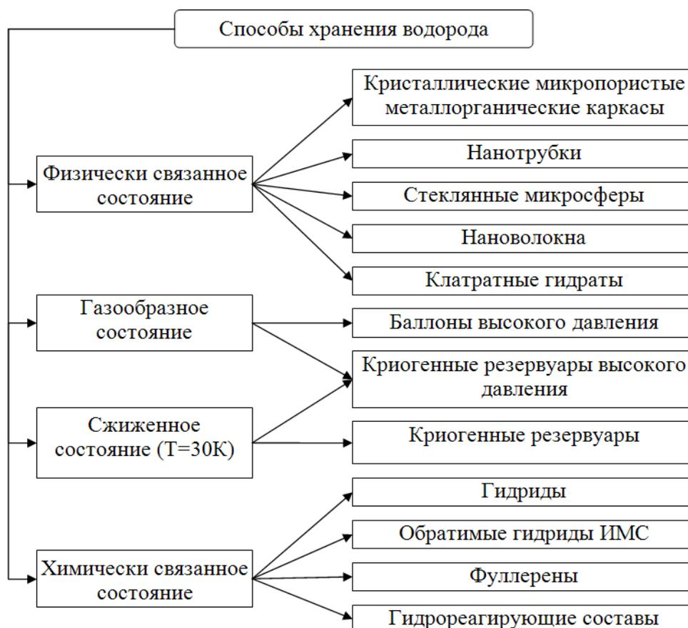
Рис. 5 – Способы хранения водорода
