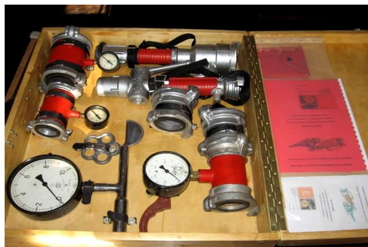
Рис. 3.9 – Валіза для перевірки мереж протипожежного зовнішнього та внутрішнього водопостачання на водовіддачу
