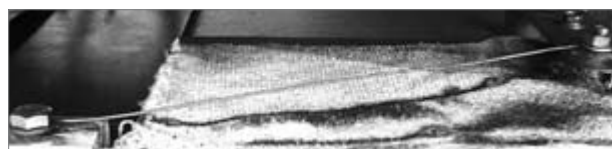
Рис. 1. Общий вид размещенного в атмосферном воздухе над теплозащитным асбестовым полотном круглого сплошного оцинкованного стального провода ( r_0 = 0,8 мм; l_0 = 320 мм; \Delta_0 = 5 мкм; S_0 = 2,01 мм 2 ) до протекания по нему в разрядной цепи высоковольтного генератора ГИТ-5С аperiodического импульса сверхтока i_0(t) большой плотности
