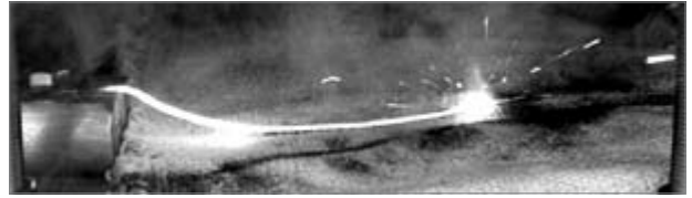
Рис. 2. Тепловое состояние оцинкованного стального провода ( r_0 = 0,8 мм; l_0 = 320 мм; \Delta_0 = 5 мкм; S_0 = 2,01 мм 2 ) с одним “горячим” (посередине провода шириной \Delta z_r \approx 7 мм) и двумя “холодными” (шириной около 156,5 мм при частичной сублимации одного из них) продольными участками после воздействия на него аperiodического импульса сверхтока i_0(t) временной формы 9 мс/576 мс большой плотности ( I_{0T} = 745 А; \delta_{0T} \approx 370 А/мм 2 ; n = 1 )
