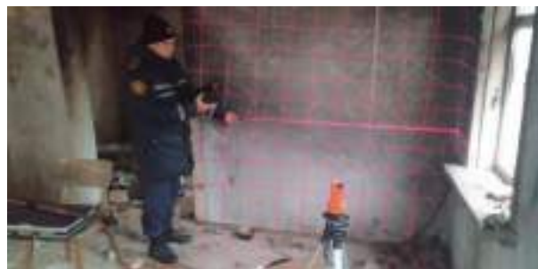
Рис. 1. Дослідження кіптяви в осередку пожежі за допомогою датчиків горизонтальної поверхні та нанесення лазерних позначок на стіни
