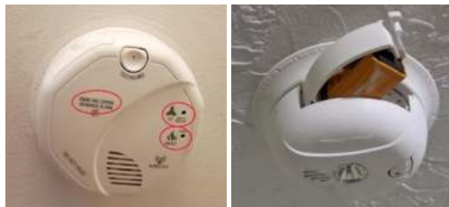
Рисунок 1 – Комбінована автономна сигналізація диму та чадного газу
