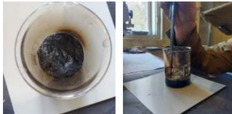
Рисунок 1 – Зразки спученого покриття після проведення випробувань
