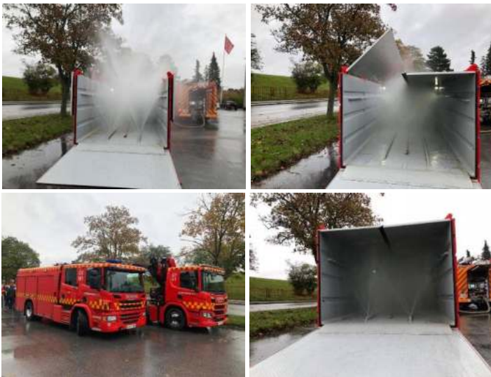
Рисунок 3 – Устаткування для гасіння електроавтомобілів (розробка Королівства Данії) [1, с.90]
