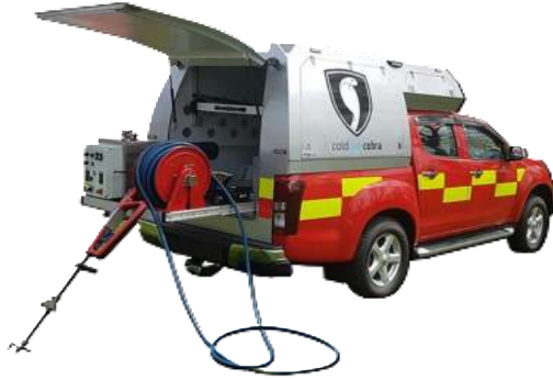
Рисунок 2 – Система Cobra Compact на базі легкової машини підвищеної прохідності
