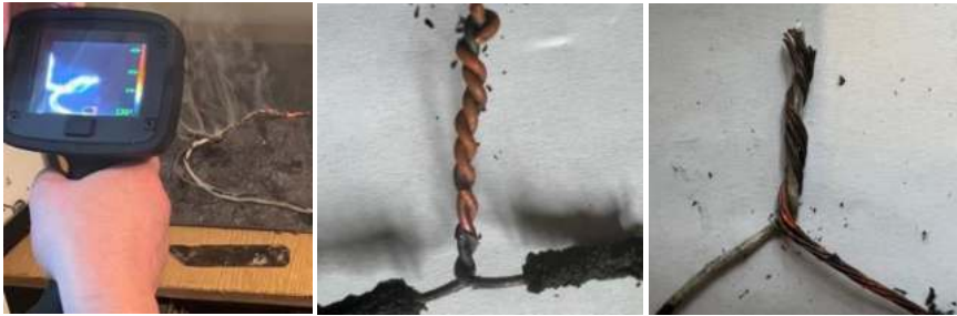
Рисунок 3 – Фіксування температури нагрівання у місці з'єднання за допомогою тепловізора «ЗМТМ SCOTTТМ V206»
