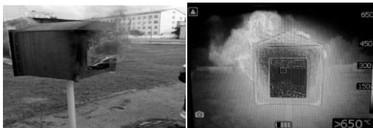
Рисунок 5 - Макет будинку для дослідження розвитку пожежі
